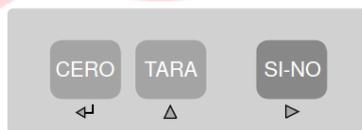
**CERO:** Pone en cero la indicación de la balanza, siempre que esté encendido el indicador de equilibrio y que la carga no supere el 4% de la capacidad máxima.
